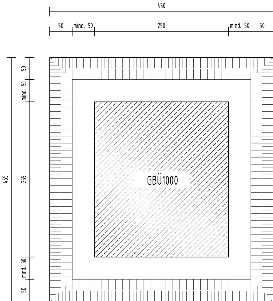
Bei der vorliegenden Gründungsvariante gehen wir von einer zulässigen Bodenpressung von 200 kN/qm aus. Die einwandfreie Beschaffenheit des Baugrundes und die Zulässigkeit der aufliegenden Baugrundbelastung sind örtlich und eigenverantwortlich zu prüfen. Sollten ungünstigere Bedingungen vorgefunden werden, so ist die Gründungsberechnung zu überarbeiten!
