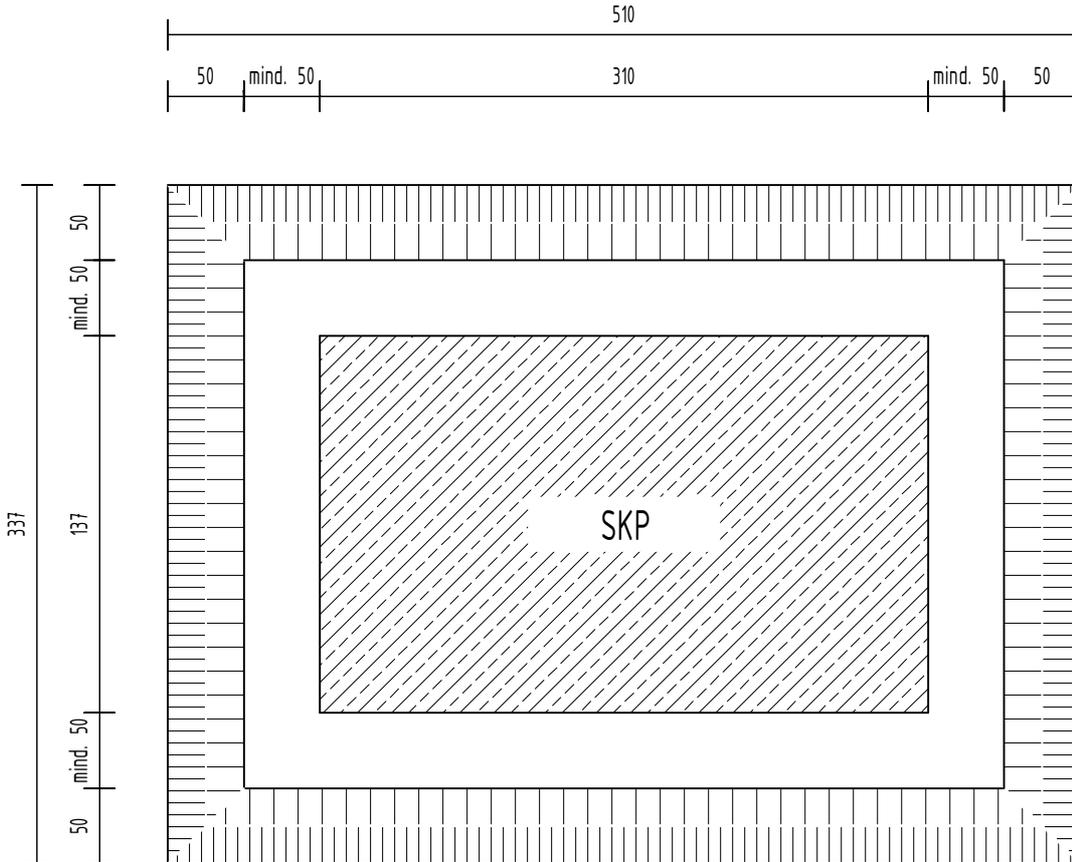
Bei der vorliegenden Gründungsvariante gehen wir von einer zulässigen Bodenpressung von 200 kN/qm aus. Die einwandfreie Beschaffenheit des Baugrundes und die Zulässigkeit der aufrichtenden Baugrundbelastung sind örtlich und eigenverantwortlich zu prüfen. Sollten ungünstigere Bedingungen vorgefunden werden, so ist die Gründungsberechnung zu überarbeiten!
