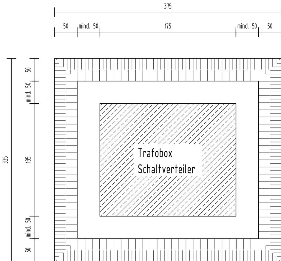
Bei der vorliegenden Gründungsvariante gehen wir von einer zulässigen Bodenpressung von 200 kN/qm aus. Die einwandfreie Beschaffenheit des Baugrundes und die Zulässigkeit der aufliegenden Baugrundbelastung sind örtlich und eigenverantwortlich zu prüfen. Sollten ungünstigere Bedingungen vorgefunden werden, so ist die Gründungsberechnung zu überarbeiten!
